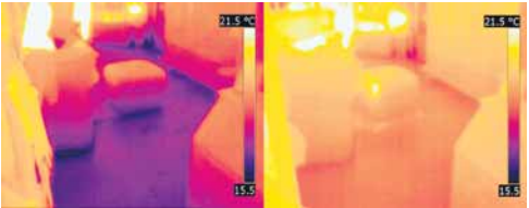
Links niet geïsoleerd, rechts isolatie met TONZON
